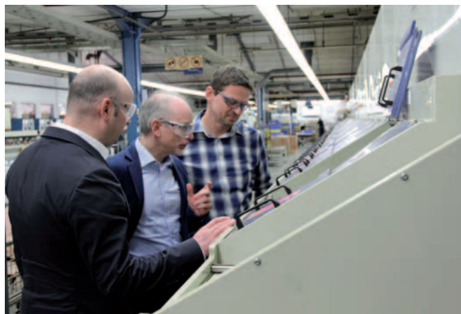
Zwei Bandanlagen mit unterschiedlichen Selektivtechniken beschichten am Standort in Weinstadt bis zu 100 Millionen Kontakte für rund 90.000 verschiedene Produkte im Jahr.
